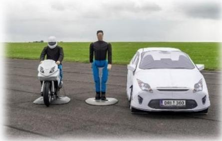
חיישני מכ"ם. מטרות אלו עומדות בהגדרות תקני NCAP ותקני האיחוד האירופאי לבחינת מערכות עזרה לנהג (ADAS) בכלי רכב.
