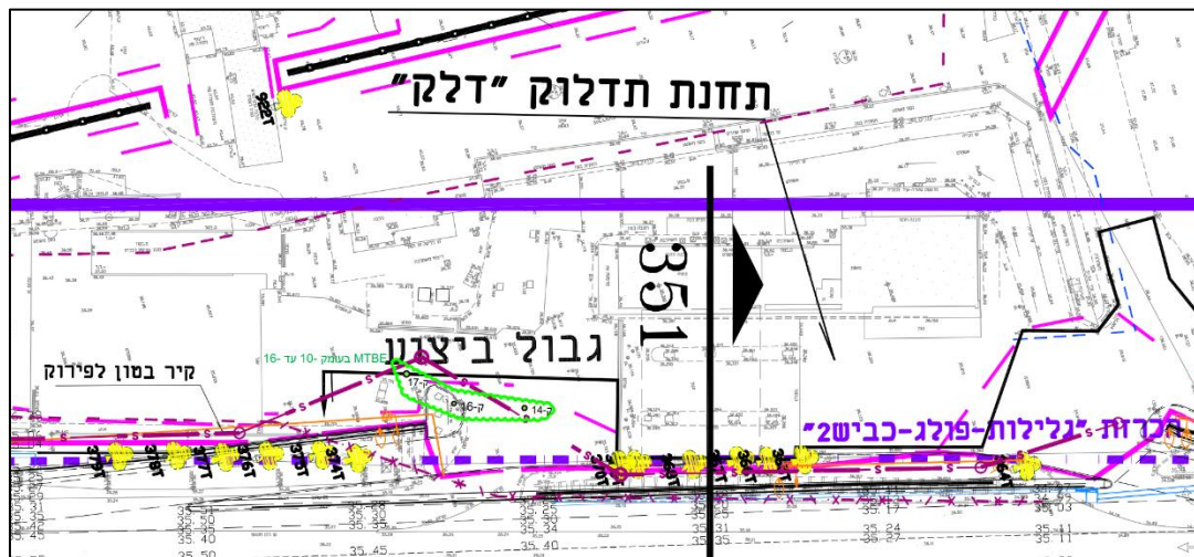
תרשים 17 – גבול העבודות המתוכננות (קו מגינטה) על רקע מדידה של תחנת תדלוק דלק "השחר". המוקד בו קיים זיהום ב-MTBE בעומק 10-16 מ' (במסגרת מודל התיעדוף) מוצג בענן בצבע ירוק.
